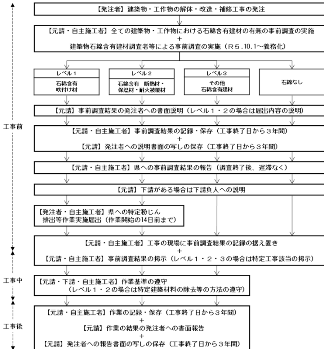
図1 建築物・工作物の解体・改造・補修工事における大気汚染防止法の規制の概要
