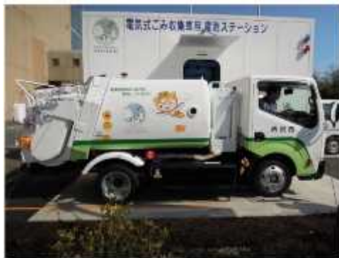
バッテリー交換型EVパッカー車と給電・蓄電システム(電池ステーション)
